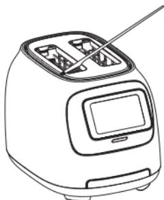
Utilice la herramienta de limpieza proporcionada por Tineco para limpiar las migas de la tostadora. No utilice herramientas afiladas que puedan dañar el aparato. Desenchufe la tostadora, póngala boca abajo y sacúdala suavemente para retirar los restos de migas.
